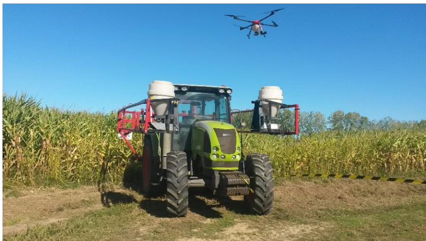
Semis de couverts à la volée: le semoir « Maxi Couv » (Ets Devrand) et le drone quadricoptère RDM AG (Reflét du Monde)
